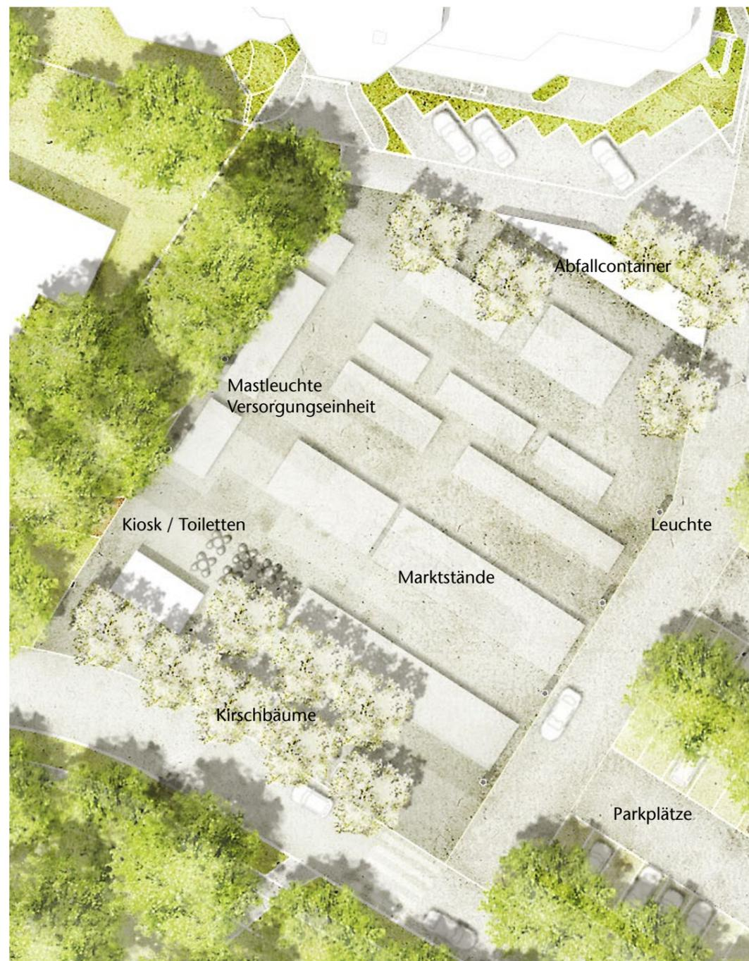
Ausgeleuchtet ist die Platzfläche von hohen Mastleuchten mit mehreren Strahlern, die einerseits die tägliche Beleuchtung leisten, andererseits Veranstaltungen gesondert ausleuchten können. Für den Wochenmarkt, Feste und Veranstaltungen stehen Versorgungspoller mit Strom und Wasser zur Verfügung. Der Parkplatz mit 36 dauerhaft geplanten Stellplätzen obliegt teils den Anrainern, ist aber größtenteils für die Besucher des Wochenmarkts oder der Innenstadt gedacht.
